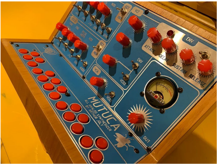
FIGURA 80 – Sintetizador Mutuca, da RecoSynth. Detalhe dos potenciômetros, interruptores e botões.
