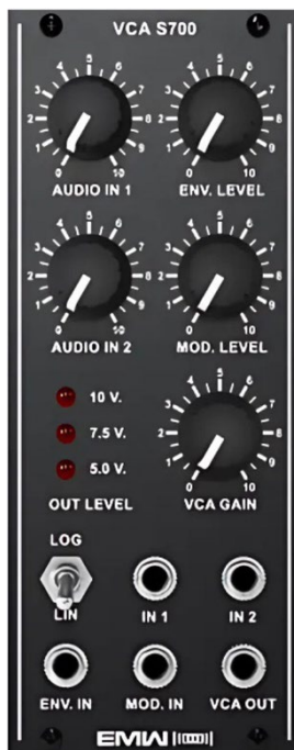
FIGURA 61 – Módulo VCA S700 com a possibilidade de modulação da amplitude.
