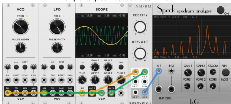
FIGURA 47 – Espectro gerado por modulação por anel em VCV Rack. A portadora é o VCO enquanto que a moduladora é um LFO.
