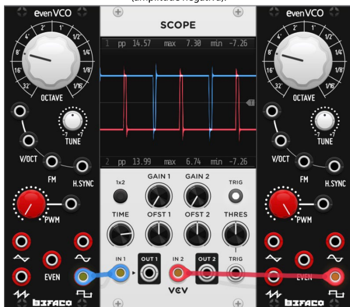
FIGURA 40 – Modulação por PWM. A onda azul apresenta um ciclo de trabalho predominante no estado positivo (maior tempo em amplitude positiva), enquanto a onda vermelha exibe um ciclo de trabalho invertido, com maior duração no estado negativo (amplitude negativa).
