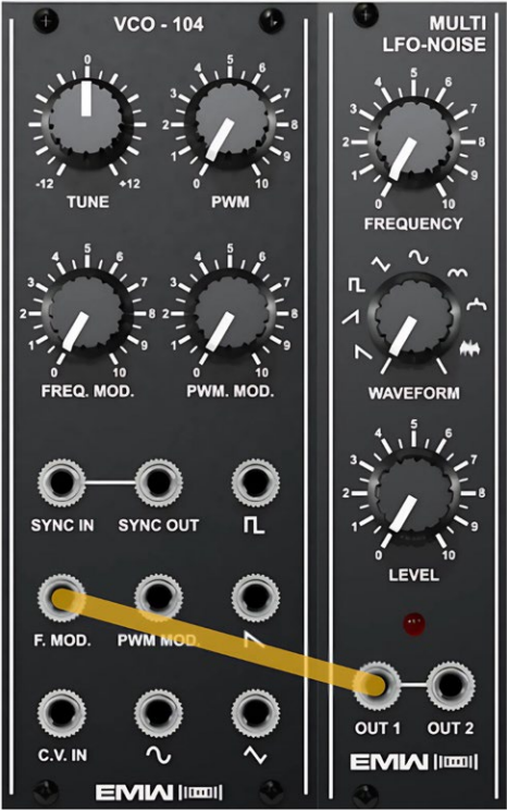
FIGURA 50 – Módulo LFO modulando a frequência de um VCO.
