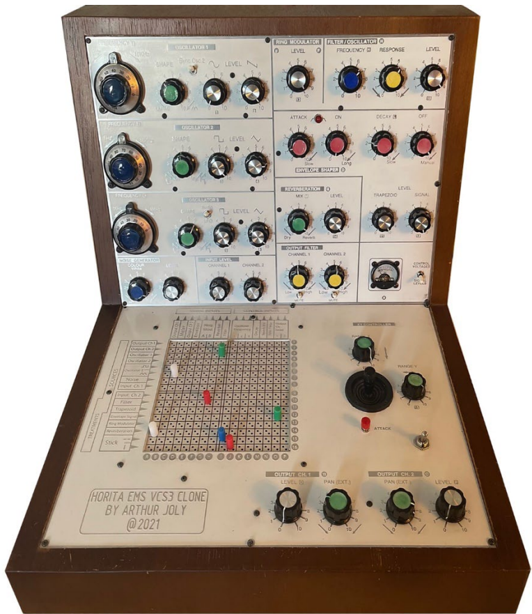
FIGURA 78 – Sintetizador VCS3 Clone, da RecoSynth. Detalhe da matriz e do joystick.
