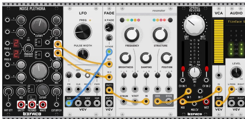
FIGURA 111 – Patch “Drone” em VCV Rack utilizando módulos externos da Befaco e Audible Instruments.
