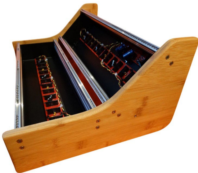
FIGURA 11 – Case da vBrazil: 2 linhas, cada uma com os conectores internos, ao fundo, para fornecer alimentação elétrica, e nas extremidades de cada linha os trilhos para fixação dos módulos com parafusos.
