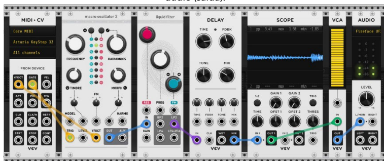
FIGURA 13 – VCV Rack com alguns módulos. Fluxo de sinal (e módulos) da esquerda para direita: interface MIDI (entrada), oscilador (clone Plaits da Mutable Instruments), filtro (clone Ripples da Mutable Instruments), delay, visualizador de forma de onda, VCA, interface de áudio (saída).
