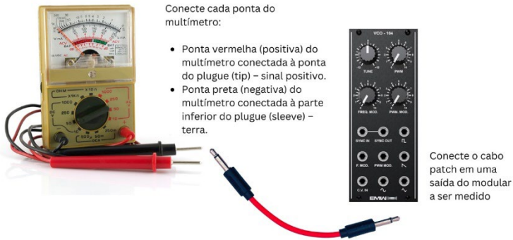
FIGURA 100 – Ilustração de um multímetro, de um cabo de patching Eurorack e de um VCO da EMW com entrada para controle de 1V/oitava.
