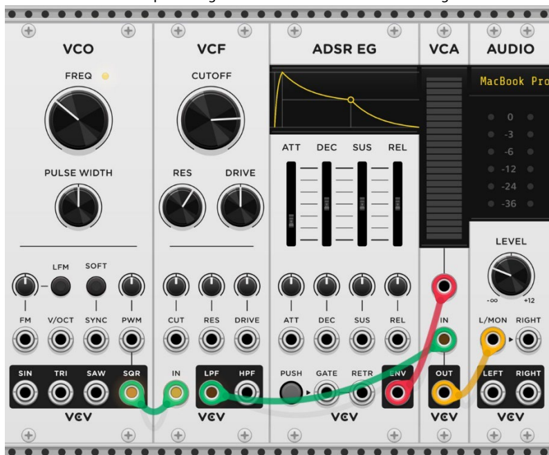
FIGURA 102 – Módulos VCO, VCF, ADSR EG e VCA no software VCV Rack. O módulo “Audio” representa a conexão entre o software e a interface de áudio do computador. Por essa razão, ele não pertence ao universo dos modulares analógicos, mas é uma funcionalidade necessária para integrar o software ao sistema de áudio digital.
