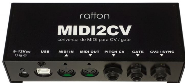
FIGURA 44 – Interface MIDI e CV de Miguel Ratton.
