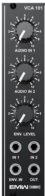
FIGURA 60 – Módulo VCA com as conexões e controles de sinal e de envelope.
