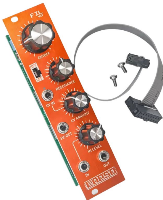
FIGURA 66 – Módulo da LAPSO, com chave seletora entre filtro do tipo LPF e BPF.
