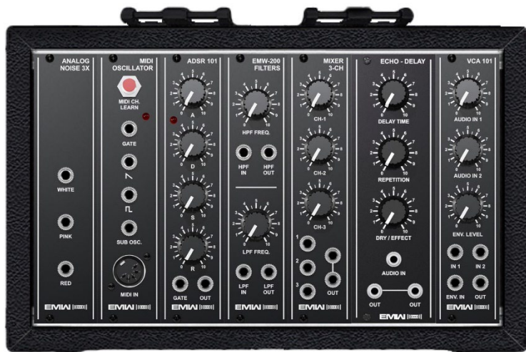
FIGURA 5 – Sintetizador do fabricante paulista EMW. Da esquerda para direita: gerador de ruído, oscilador, envelope, filtro, mixer, delay e amplificador.
