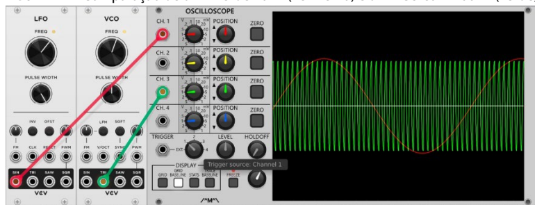
FIGURA 71 – Comparação de um LFO de 10Hz (vermelho) e um VCO com 400Hz (verde).
