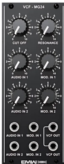
FIGURA 65 – Módulo EMW MG24 baseado nos filtros da Moog.
