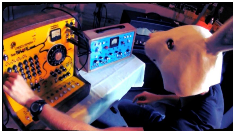
FIGURA 81 – Sintetizador Phonedrone (ao lado esquerdo, em amarelo), da RecoSynth. Detalhe do discador.
